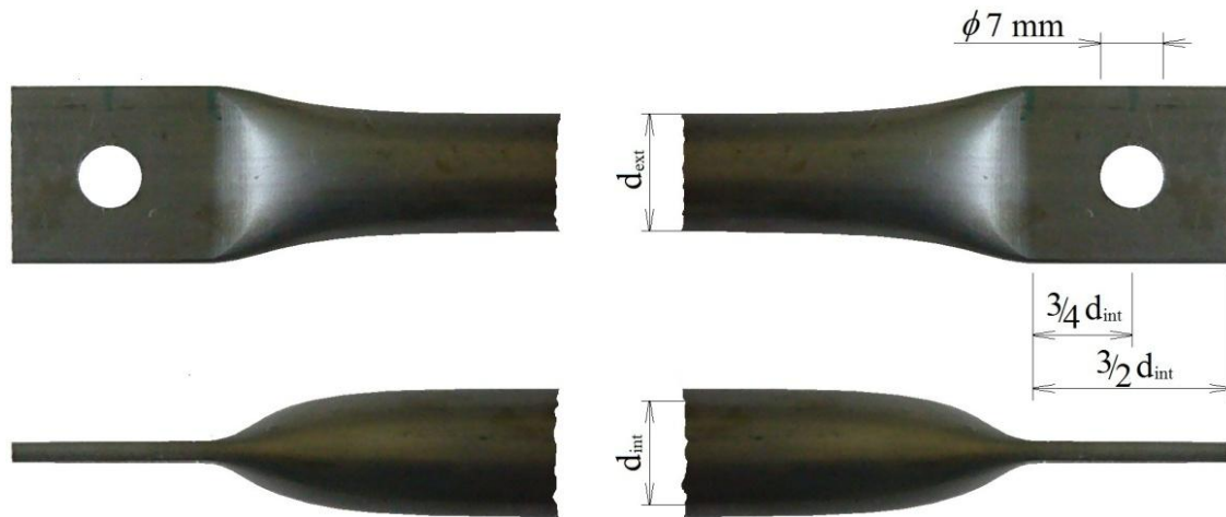
Obr. 2 Úprava koncov rúrok
